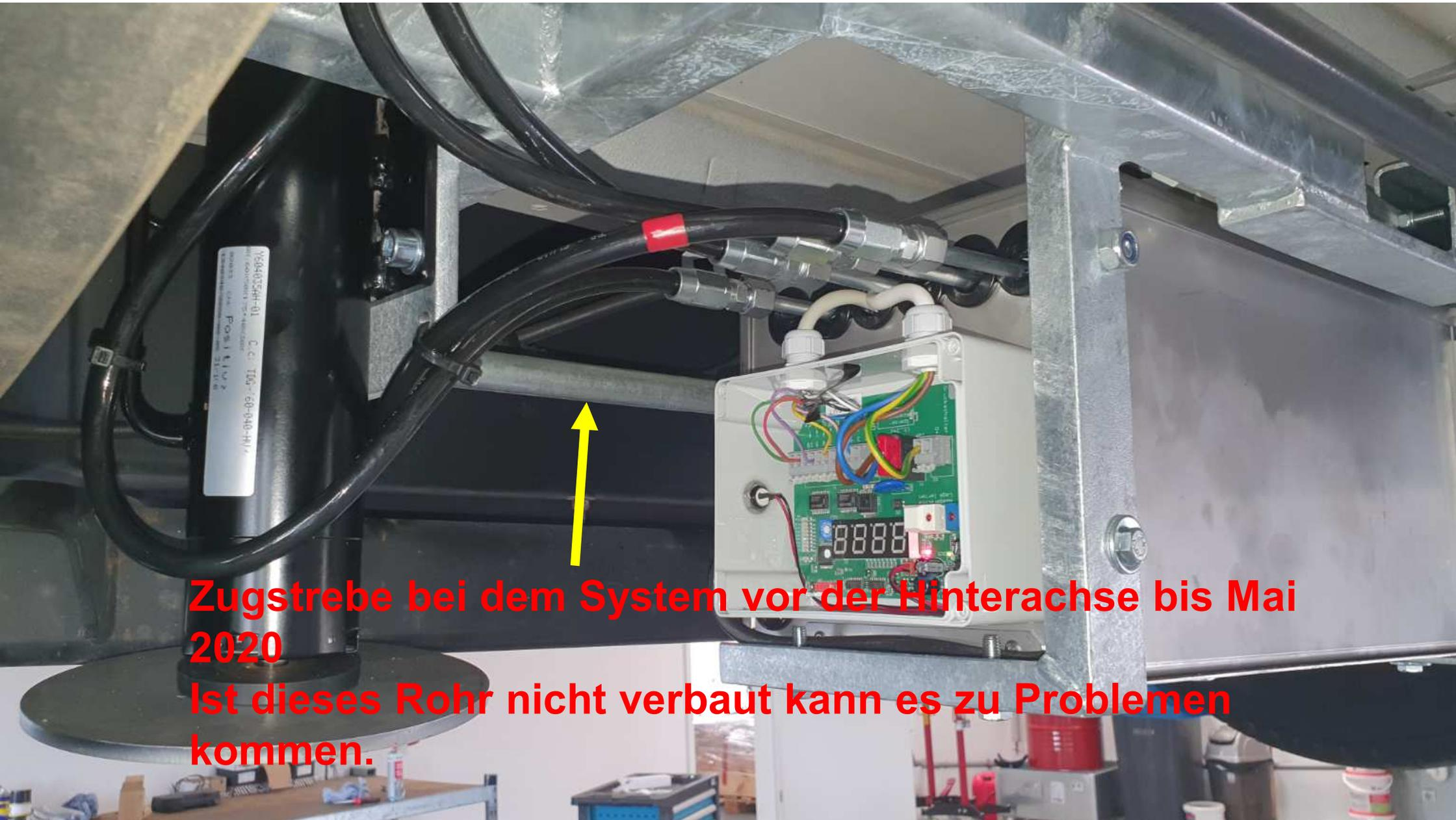
**Zugstrebe bei dem System vor der Hinterachse bis Mai 2020
