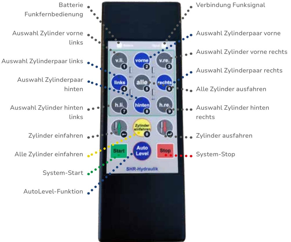
**Hinweis:** Die Ziffern auf den jeweiligen Tasten dienen nur zur Eingabe des Kopplungs-Codes für die Smartphone-App und haben für die Bedienung der Zylinder keinerlei Bedeutung!
